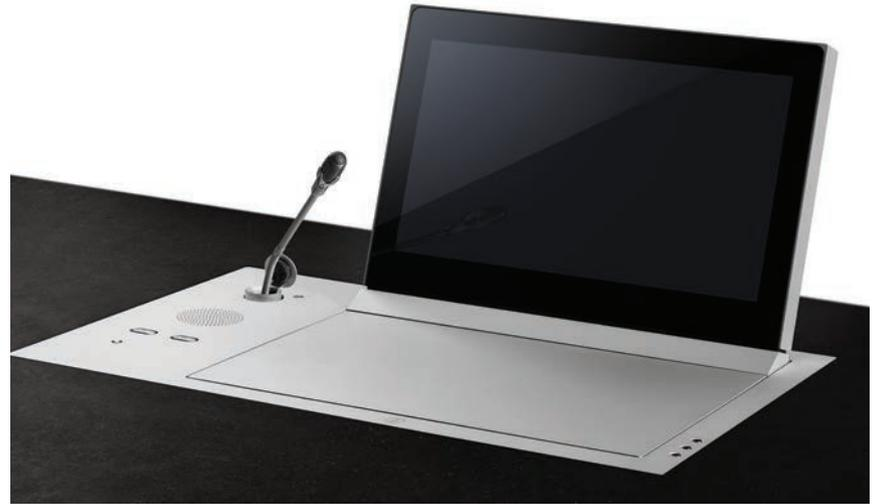
**D**ynamic3Talk ist ein motorisiertes Monitorsystem mit maximaler Bandbreite an Bewegungen und Möglichkeiten ergänzt um die eigenständige Halterung für Schwanenhalsmikrofone, in einem einzigen Rahmen eingelassen zur einfachen und sauberen Integration in den Konferenztisch oder Infopoints. Eine intelligente Kombination aus Design, Technologie und Ergonomie mit hochwertigen Materialien aus Aluminium und Glas. Dies ermöglicht zum einen ein komplett
